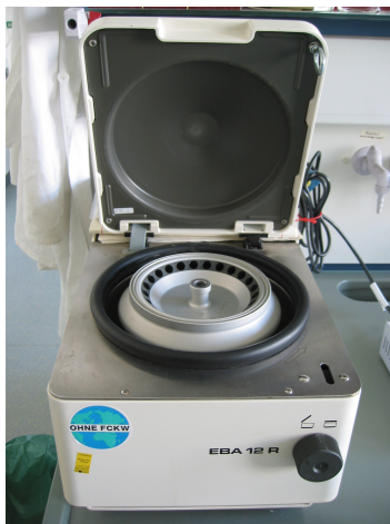
Figuur 3.11 Links een eppendorf-tafelcentrifuge. Rechts wat er kan gebeuren als je het verkeerde type rotor gebruikt in een ultracentrifuge. Bij dit ongeluk in 1998 werd een ruimte compleet vernield.
